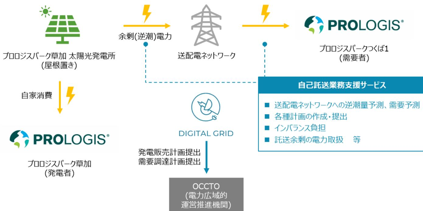
物流施設の開発・所有・運営を行うプロロジスの「プロロジスパーク草加」（埼玉県草加市）の屋根上に約 2.2MW（DC）の太陽光発電設備（PV）を設置し、発電した電力のうちプロロジスパーク草加で自家消費した電力を除く余剰電力を、電力会社の送配電ネットワークを介して、プロロジスの「プロロジスパークつくば1」（茨城県つくば市）へ自己託送で供給します。
